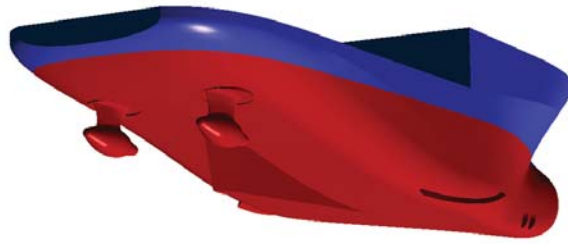
Рис. 4. 3D-модель окончательной судовой поверхности (вариант 8) с выступающими частями
