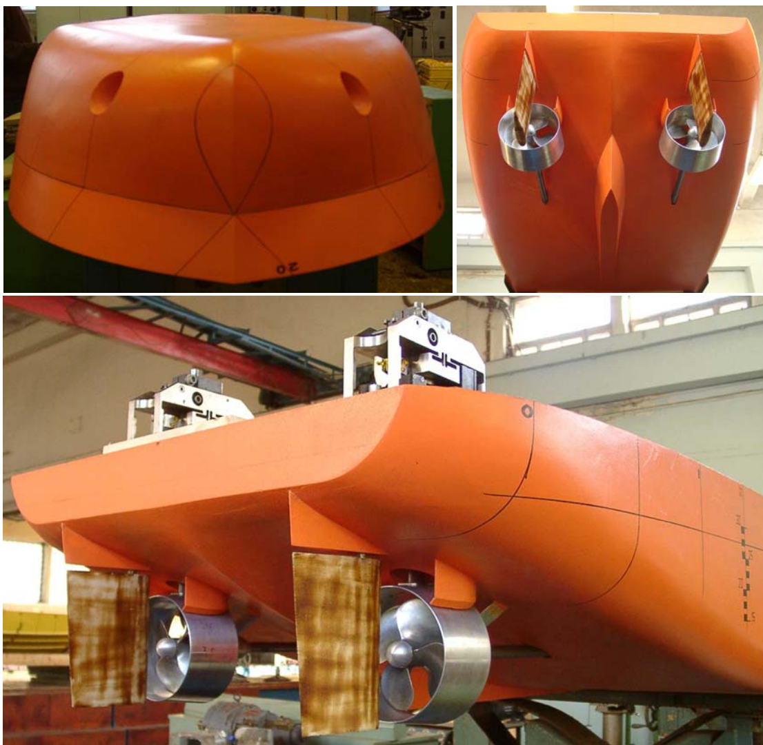
Рис. 7. Самоходная модель судна проекта RSD19, выполненная ЦНИИ им. акад. А.Н.Крылова
